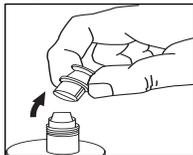
IX. Inserte el puerto de control de flujo en la punta del cartucho.
