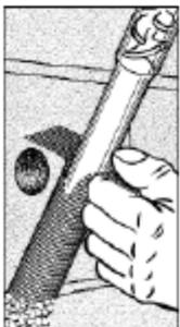
**V.** Inserte la boquilla mezcladora en el fondo de la pantalla y llene completamente mientras retira la boquilla. Llene la pantalla completamente hasta el final para asegurar que el epóxico llene completamente la pantalla de principio a fin cuando se inserte la barra roscada.
