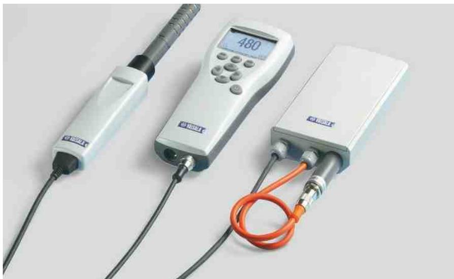
*El medidor portátil Vaisala CARBOCAP® GM70 es la elección del profesional exigente para la medición de dióxido de carbono. El medidor consiste en un indicador (centro) y una sonda, usados con un mango (izquierda) o una bomba (derecha).*
