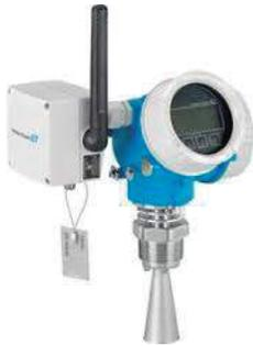
WirelessHart: el adaptador WirelessHart permite integrar cualquier equipo 4-20mA/HART en la red. El Gateway almacena los valores transmitidos y los pone a disposición a través de una interfaz Ethernet o RS 485.
