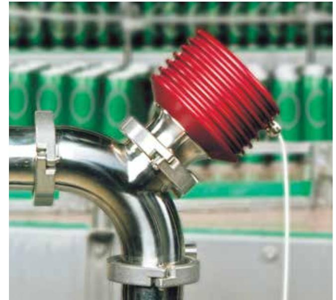
El uso del refractómetro sanitario K-PATENTS de Vaisala para la medición de Brix en línea permite la automatización del procesamiento de alimentos líquidos y bebidas y garantiza:
