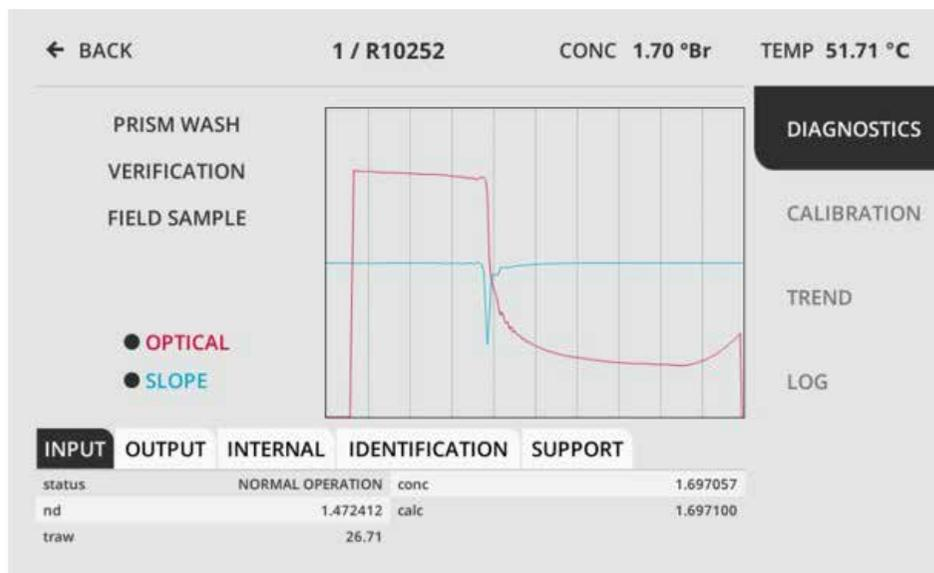
Figura 3. Pantalla de diagnóstico del refractómetro sanitario K-PATENTS de Vaisala
